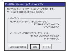
⑦インストールが正常に終了した場合、以下のようなメッセージが表示されます。本製品を取り外し、「OK」ボタンを選択してください。センサコントローラが再起動します。
